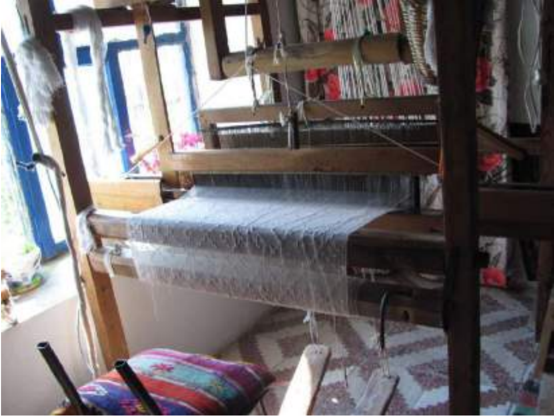
Fotoğraf 7. Tezgâh tefe-tarak, mekik, gücüler, ayakçak ve dokunmuş dastarın selmine sarılmış görüntüsü.
