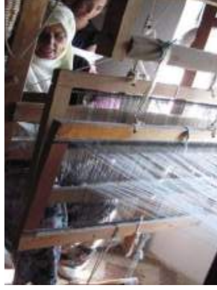
Fotoğraf 6. Tezgâh tefe-tarak, gücüler ve ayakçak bağlantı detay görüntüsü.
