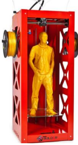
Resim 111. FDM tekniđiyle baskı yapan bir 3B yazıcı ve içinde çıktı obje
